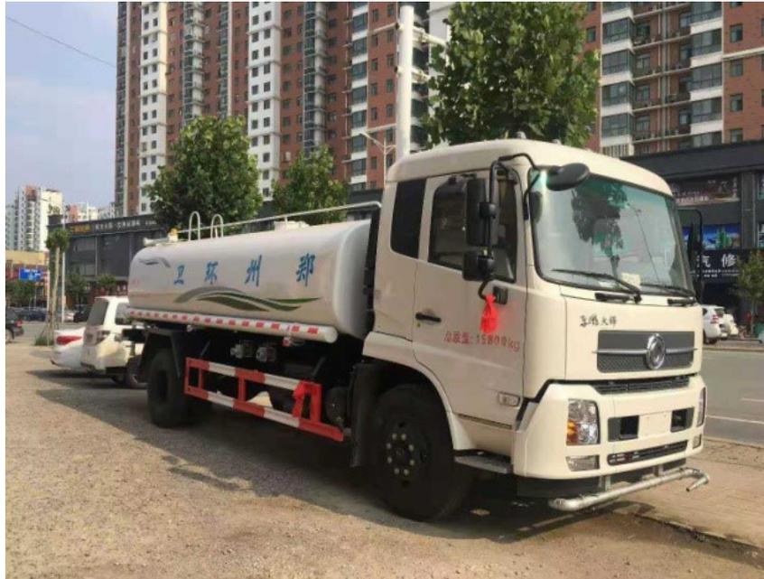
新款东风天锦洗扫车配有先进的语音提示报警装置，能够准确的播报各种安全提示和故障。水箱内设有低水位传感报警系统，无水时自动报警，防止水泵缺水损坏。垃圾箱内设置有防溢满报警装置，防止污水作业时从吸管溢出，造成二次污染，整车具有倒车保护装置，倒车时自动收回工作装置。
