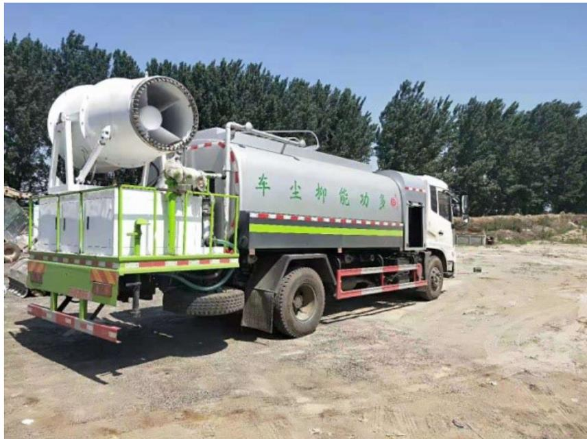
洒水车前喷头位置较低，靠近地面，喷洒压力较大，可用于冲洗路面；后喷头位置较高（洒水车后喷头一般左右各安装一个），洒水面较宽，可用于公路施工洒水，使用后喷头时，应将前喷管关闭；使用可调喷头洒水时，洒水宽度可根据需要调整。洒水宽度越宽，中间重叠量越少，洒水密度越均匀。使用过程中要定期润滑传动总成各润滑点，经常紧固联结点，以保证正常使用。水车贮水箱设有排污管，该管的进口为水箱的较低点。经过一段时间的使用，应定期打开排污管开关，将罐内积存的杂物排除，直到水变清为止。本司生产销售各种方量洒水车、抑尘车、运水车，需要详细资料及配置请电话联系！ 郑州大型洗扫车租赁价格同时可提供年租、月租、天租等各种方式。
